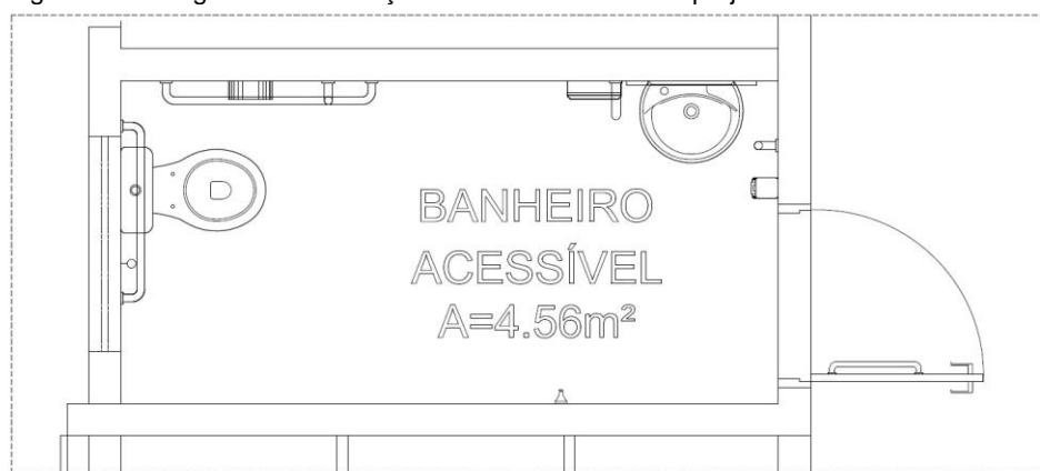
Imagem 28 – Imagem do W.C acessível no projeto. Fonte: COPROJ-SEINF.
